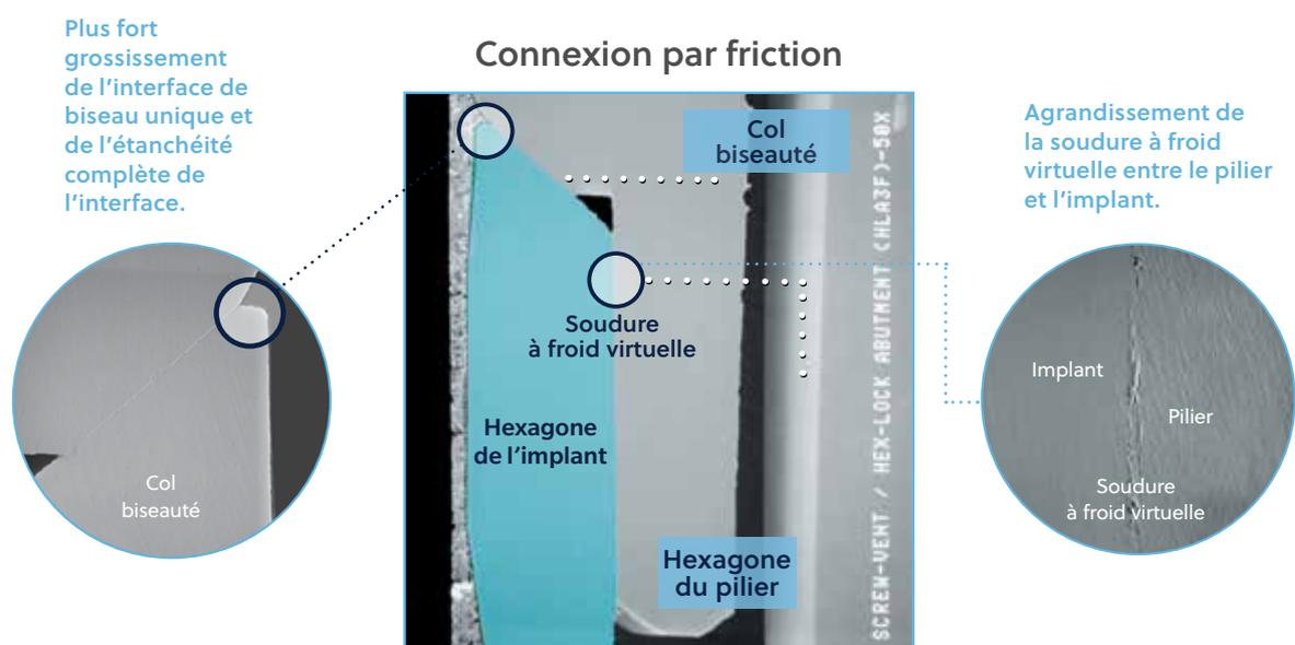
Connexion exclusive par friction et col biseauté : une soudure à froid virtuelle se forme entre l'implant à hexagone interne et le pilier à calage par friction.
